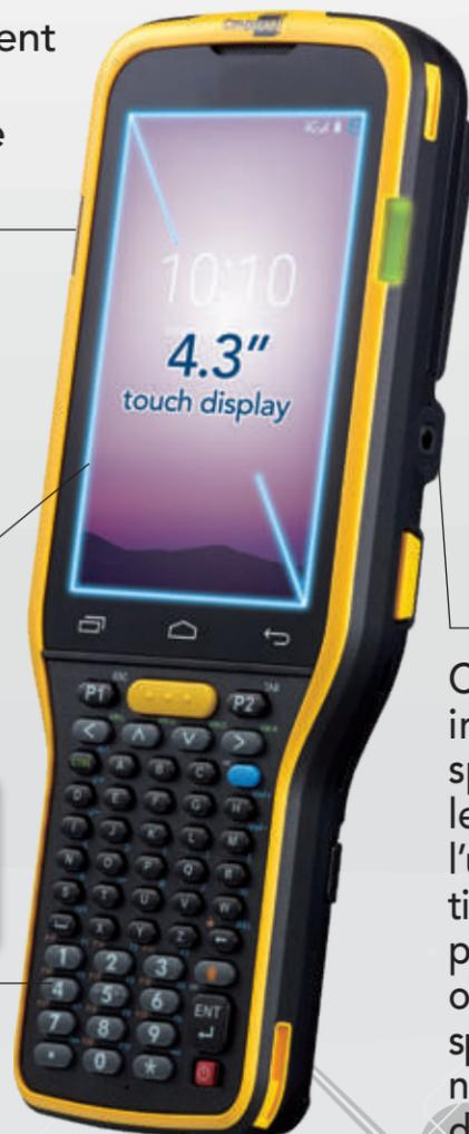
Caméra 13 MP optionnelle intégrée avec un angle spécifique pour empêcher le verrouillage manuel par l'utilisateur lorsque celui-ci la tient en main ou prend des photos. Caméra 13 MP en option intégrée avec un angle spécifique pour éviter qu'elle ne soit bloquée par la main de l'utilisateur en tenant le pistolet et prenant des photos.
